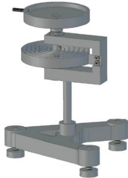
图 e.5.4 载物圆盘转动惯量测试
