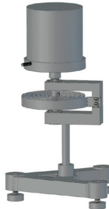
图 e.5.5 圆柱体转动惯量测试
