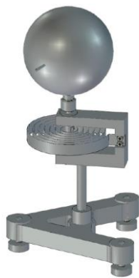
图 e.5.6 木球转动惯量测试
