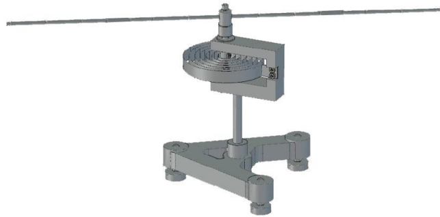
图 e.5.7 金属细杆转动惯量测试
